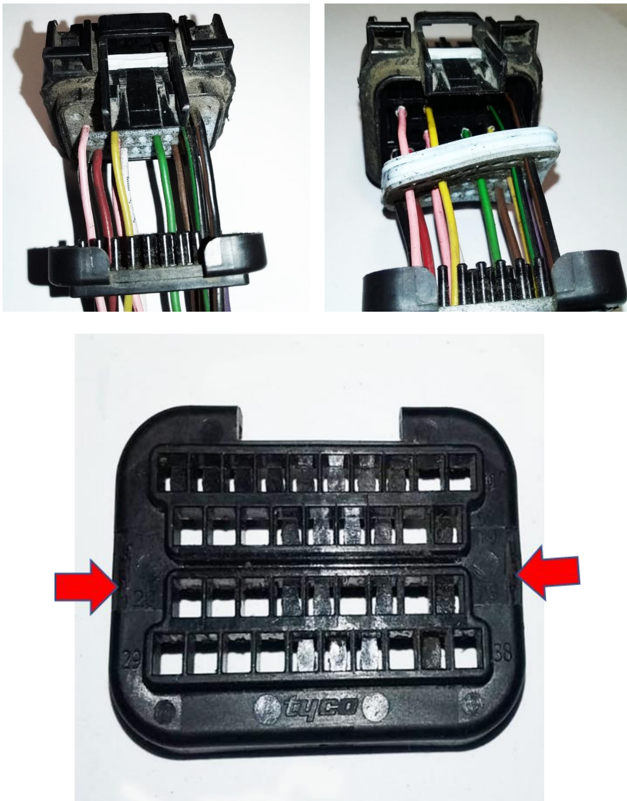
Рисунок 12 – Разборка разъёма 3-1326726-7 «TYCO»
