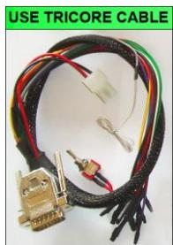
**Pin 1/1,1/8:+12V Pin 2/13:+12V Pin 3/28:K-line**
